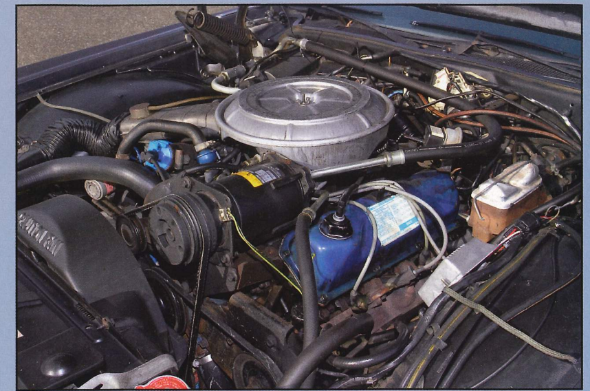
Downsizing, die Zweite: Statt des 460 ci schlug nun ein 400-ci-V8 unter der üppig bemessenen Haube
