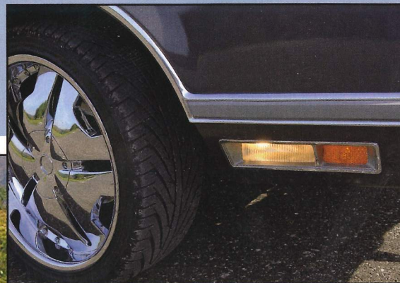
Das Abbiegelicht ("Cornering Lamps") wird bei eingeschaltetem Licht durch den Blinker aktiviert
