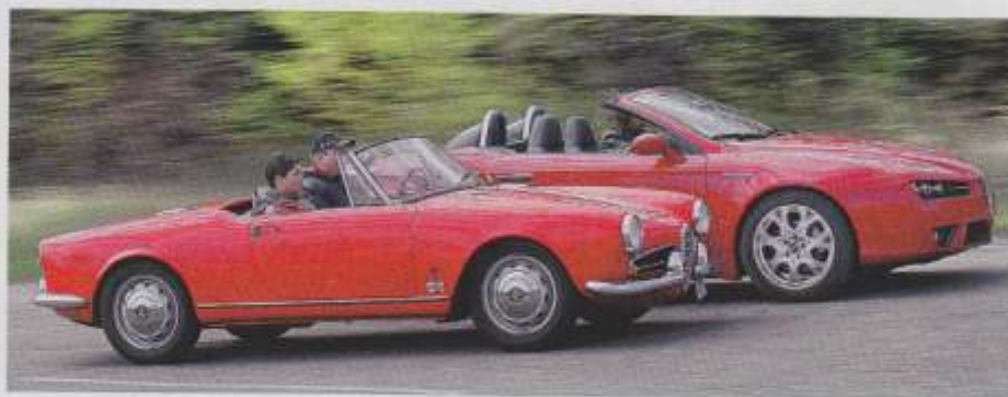
Es ist vor allem das höhere Gewicht der Neuwagen, das die Fortschritte im Motorenbau zunichte macht. Der Alfa Romeo Giulietta Spider wiegt 860 Kilo, sein Enkel bringt 1608 Kilo auf die Waage. In unserem Test verbrauchte der Oldtimer 6,9 Liter, der Neuwagen 11,2
