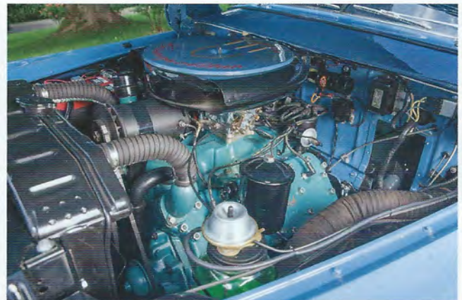
Der V8 mit 5,5 Litern Hubraum leistet um die 150 PS bei 3600 Umdrehungen pro Minute.
