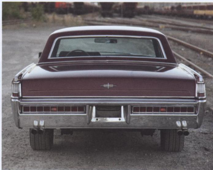
1969 wanderten die Rückleuchten in den Heckstoßfänger. Feine vertikale Chromleisten trennen jede einzelne Leuchte in neun Segmente, darunter bollern nach Herzenslust vier Endrohre
