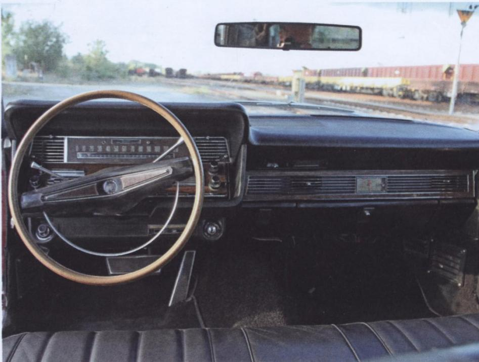
Das überarbeitete Lenkrad erlaubte einen besseren Blick auf die Armaturen
