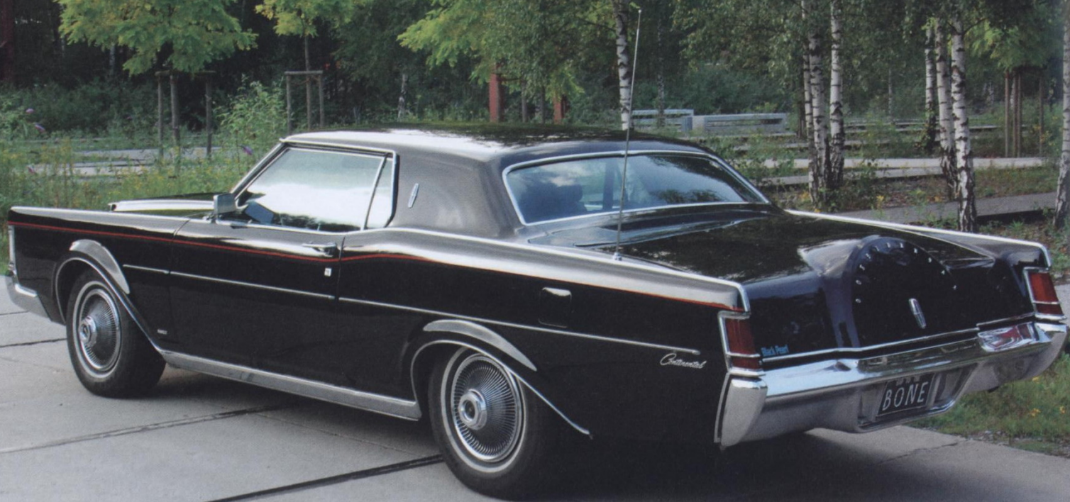
Corporate Design: Die dicke, durchgehende Zierleiste auf der Gürtellinie und die ein Stück nach innen versetzte Kabine mit „Fensterbrett“ zeichneten auch den regulären Continental aus, gleichfalls die senkrechten Frontblinker und Rückleuchten
